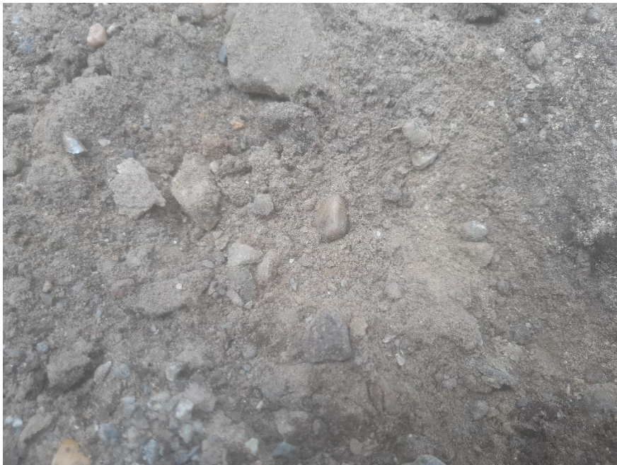
Bilder: Schurfstelle 5 (S 5): Fahrbahn- / Wegbefestigung : RC-Material mit Beton und Ziegel (25 cm) über Boden (Sand / Lehm)
