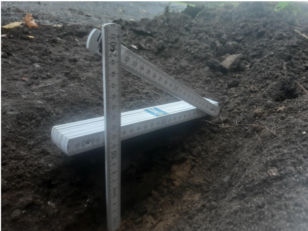
Bilder: Schurfstelle 2 ( S 2 ): Fahrbahnrand : Asphalt (11 cm) über Boden (Sand / Lehm) Bankettbereich : Oberboden mit RC-Material / Bankett (11 cm) über Boden (Sand / Lehm)
