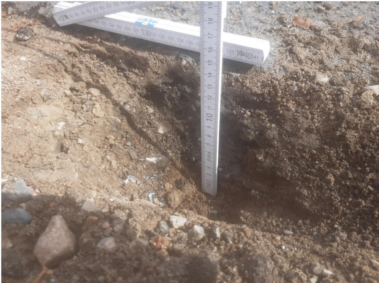
Bilder: Schurfstelle 1 (S 1): Fahrbahnrand : Asphalt (11 cm) über Boden (Sand / Lehm) Bankettbereich : RC-Material / Bankett (11 cm) über Boden (Sand / Lehm)
