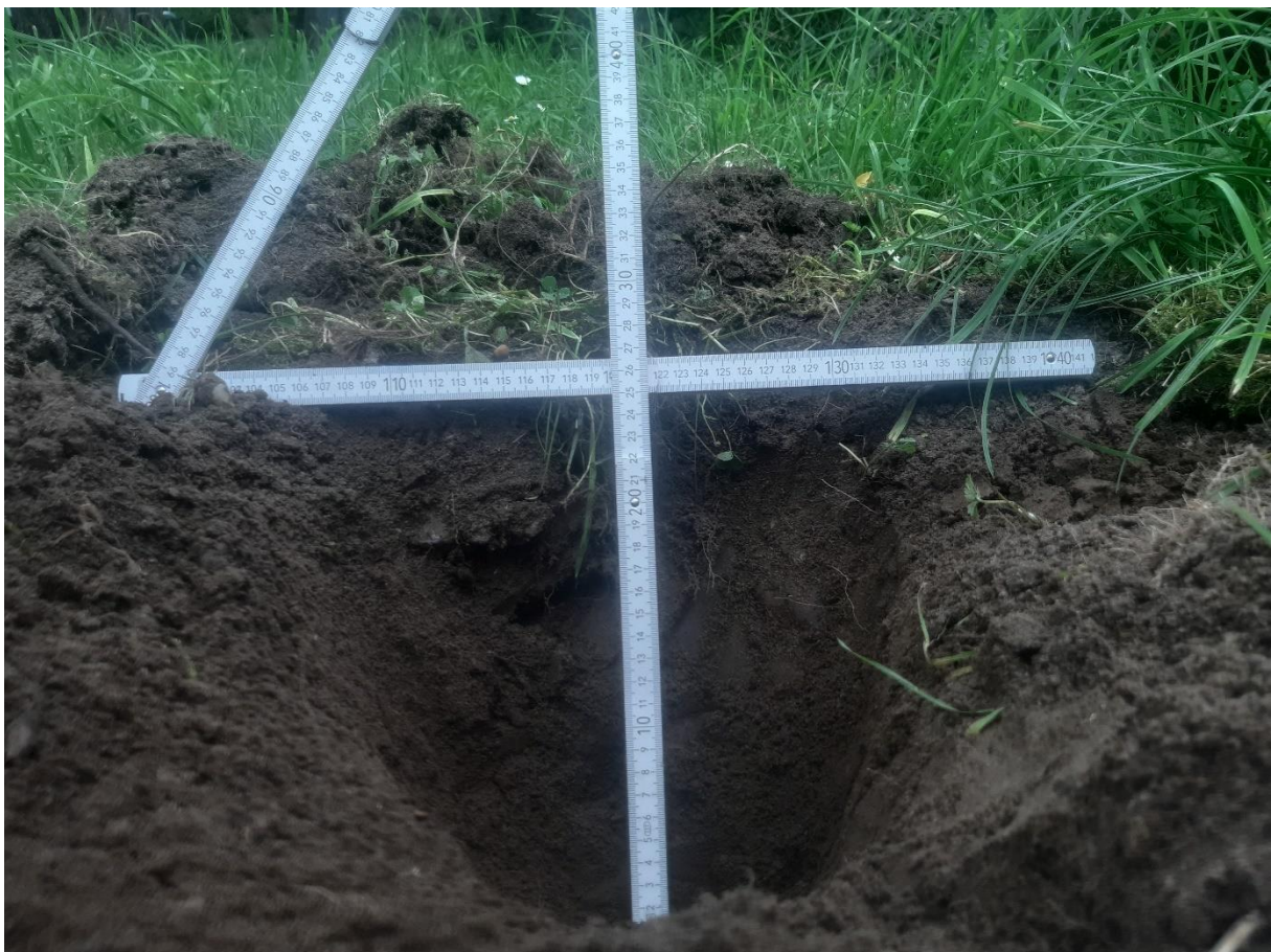
Bilder: Schurfstelle 3 (S 3): Oberboden mit RC-Material / Bankettbereich ? (25 cm) geplanter Gehwegbereich über Boden (Sand schw. humos / Lehm)
