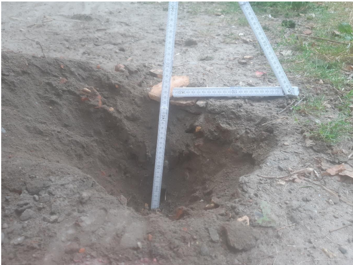
Bilder: Schurfstelle 4 (S 4): Fahrbahn- / Wegbefestigung : RC-Material mit Ziegel (25 cm) über Boden (Sand / Lehm)
